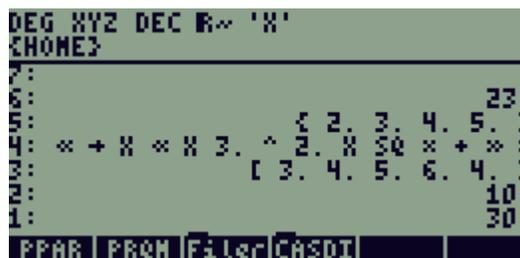
Entonces al presionar la tecla *+*, se ejecuta el operador de la suma el cual toma los dos primeros datos de la pila (los números 30 y 10), los suma y coloca el resultado en la pila, con lo que la misma queda en la forma:
