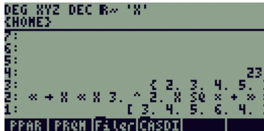
Se denomina pila (o montón) porque la información que se guarda en la misma se va apilando (o amontando). El último dato guardado es siempre el número uno y este es también el primer dato que se puede sacar de la pila, se trata entonces de una pila *LIFO* (Last In First Out).
